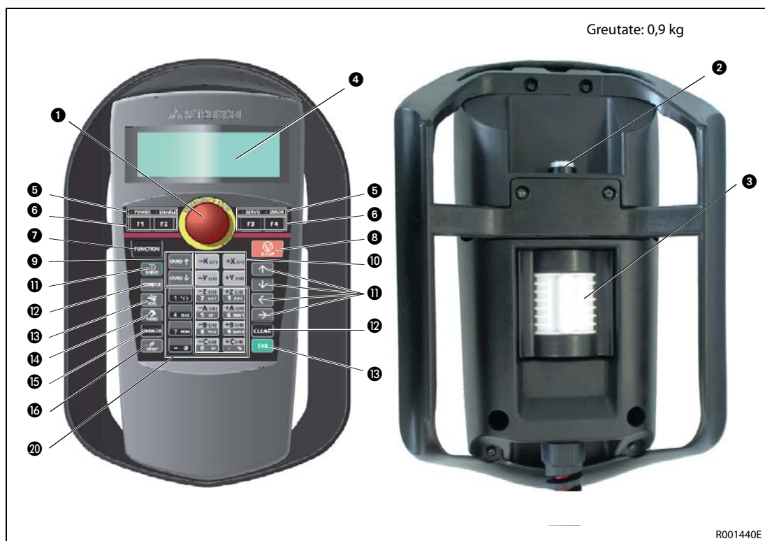
Fig. 2-14: Vederile consolei de programare R32TB
