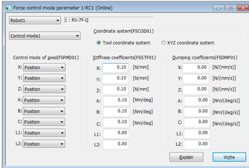
Figure 10-25 Force control mode parameter
