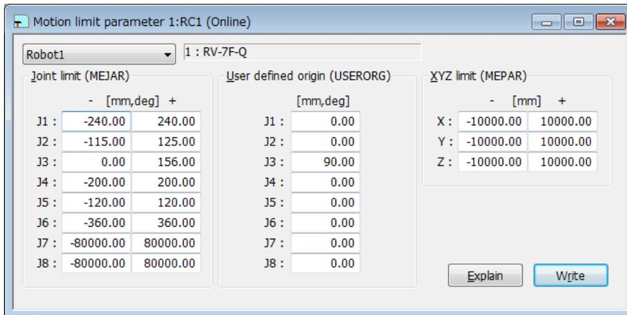
Figure 10-8 Motion limit parameter (Ver.1.2 or later)
