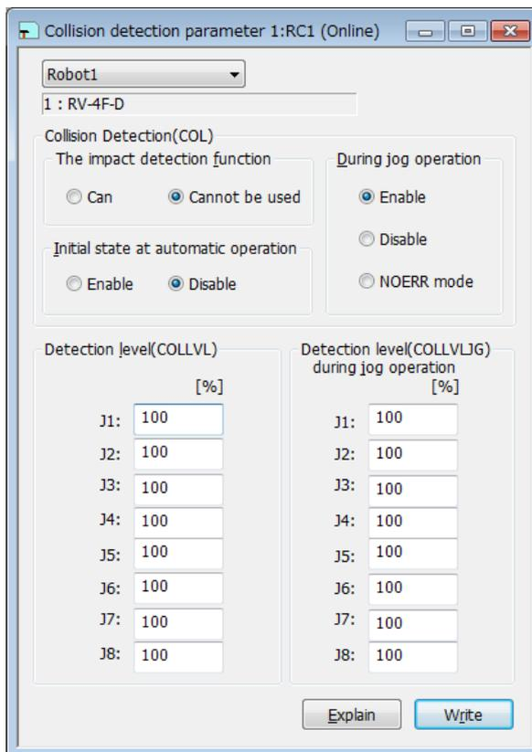
Figure 10-20 Collision detection parameter
