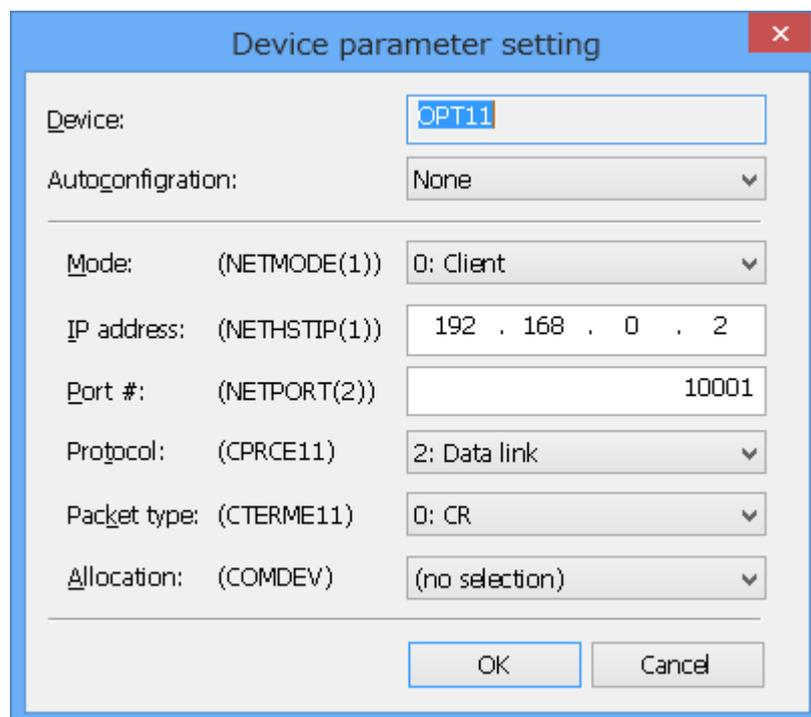
Figure 10-51 Ethernet parameter – Device parameter setting (Version 3.00A or later)
