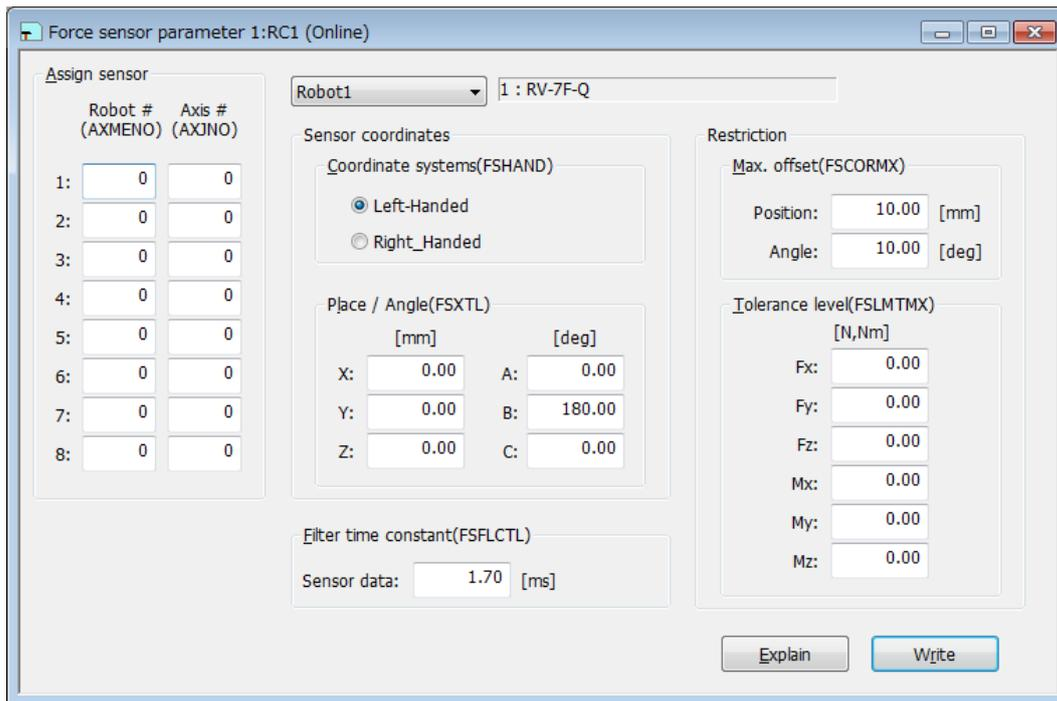
Figure 10-24 Force sensor parameter
