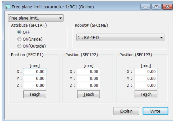
Figure 10-16 Free plane limit parameter
