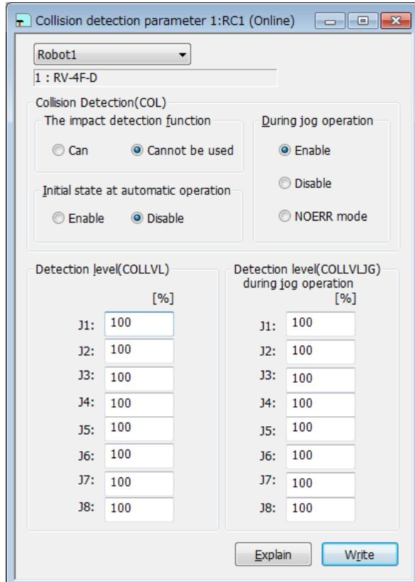
Figure 10-20 Collision detection parameter
