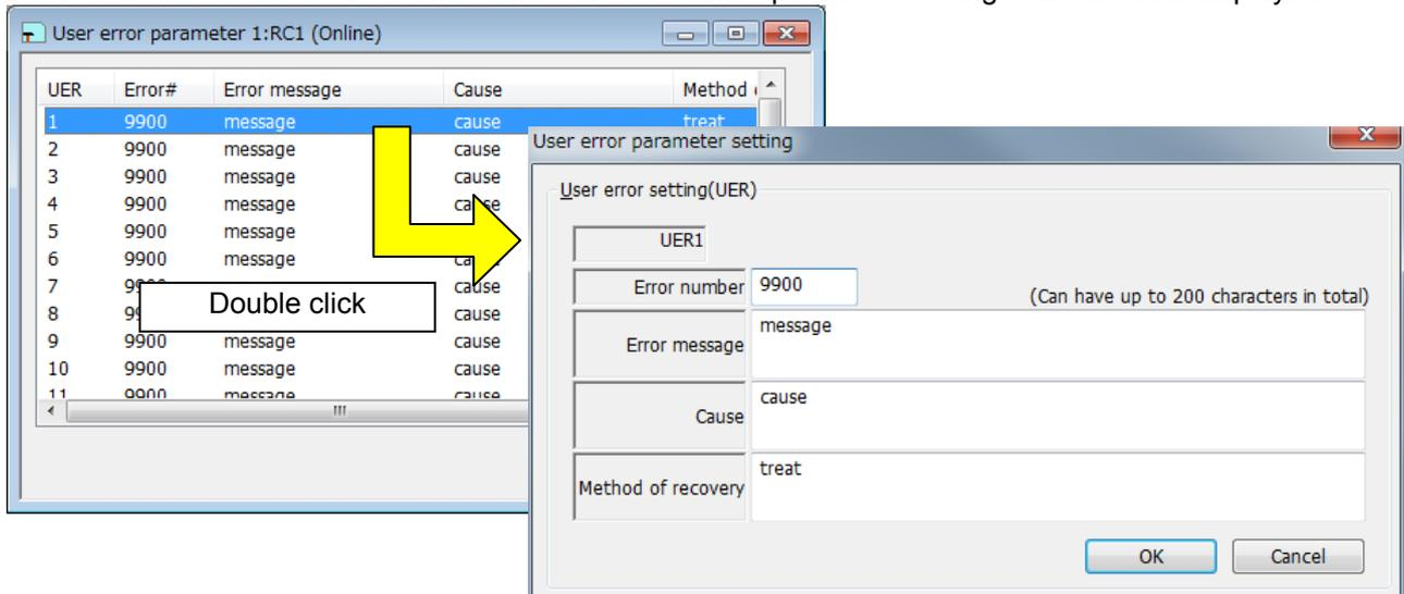
Figure 10-35 User error parameter setting
