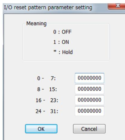
Figure 10-37 I/O reset pattern parameter setting
