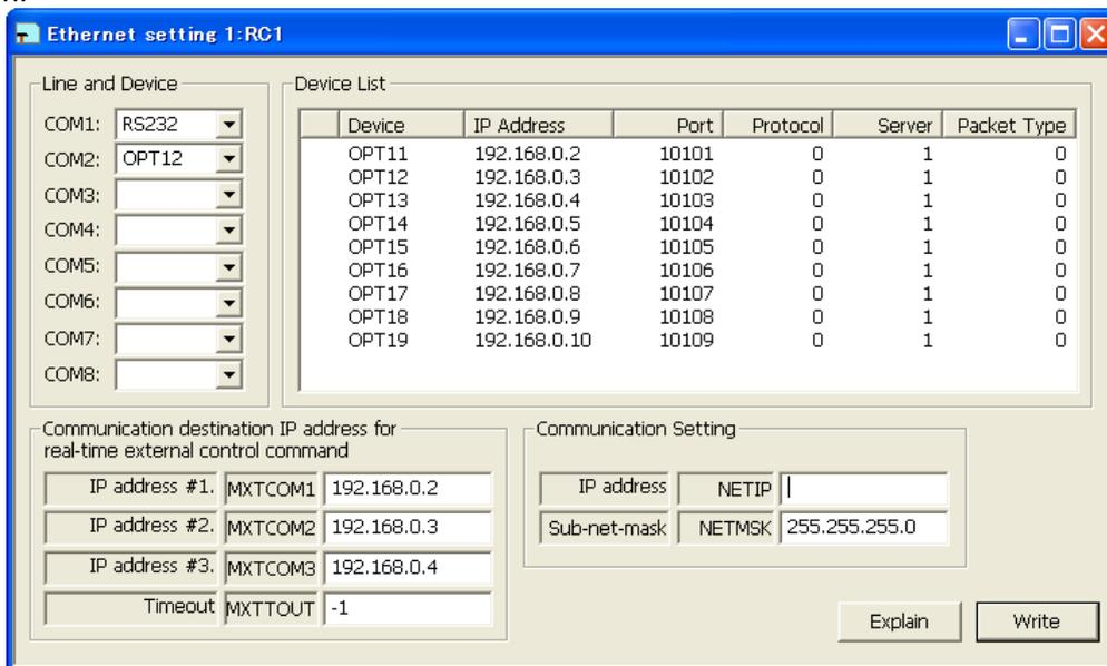
Figure 10-54 Ethernet parameter (Version 2.50C or earlier)
