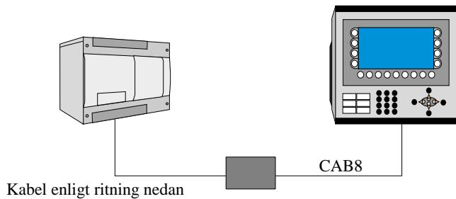
Terminalen stöder inte andra masters i nätverket. Mellan PLC systemet och terminalen ansluts kabeln CAB8. Det är en standardkabel som kan beställas från Beijer Electronics.
