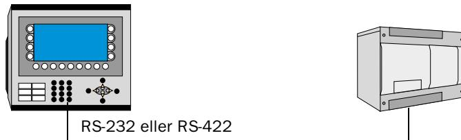
Point-to-point anslutningen görs via RS-232C porten på terminalen till RS232 gränssnittet på modulen USS21A, USS11A, MP/MPB eller AIO på SEW Eurodrive MOVIDYN omformaren. För kabelkonfiguration hänvisas till nedanstående kabelritning.
