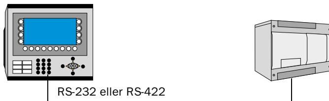
Point-to-point anslutningen görs via RS-232C porten på terminalen till RS232 gränssnittet på modulen USS21A på SEW Eurodrive MOVIDRIVE omformaren. För kabel-konfiguration hänvisas till nedanstående kabelritning.
