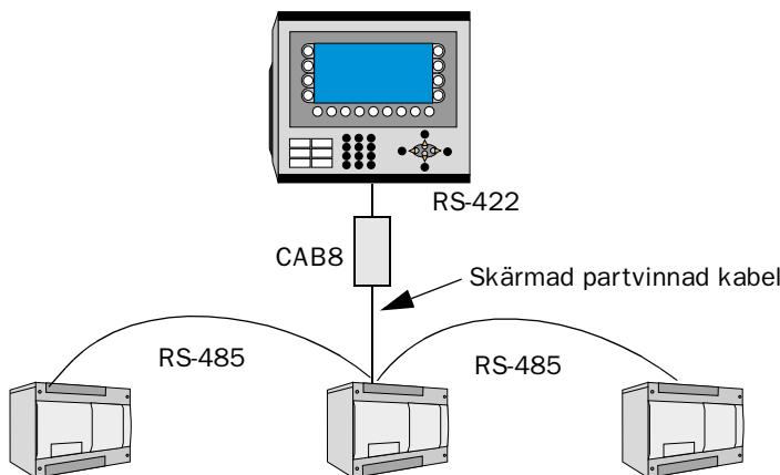
Terminalen ansluts till ett RS-485-nätverk via adapttern CAB8 vilken är ansluten till RS-422 porten på terminalen. CAB8 är en standard adapter som kan beställas från Beijer Electronics.
