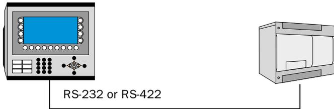
Point-to-point anslutningen kan göras antingen via RS-422 porten eller via RS-232C porten på terminalen. Systemen i Klockner Moeller PS4 serien ansluts till RS-232C porten på terminalen med kabeln enligt nedanstående ritningar eller med programmeringskabeln för PLC-systemet tillsammans med kabeladaptorn CAB12.
