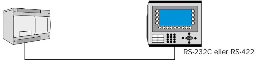
Point-to-point anslutningen kan göras antingen via RS-422 porten eller via RS-232C porten på terminalen. Vid anslutning via RS-232C porten på E-terminalen och FESTO/BECK styrsystemet skall kabel enligt följande ritningar användas.
