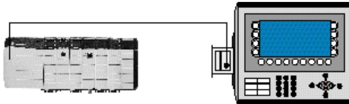
För att ansluta terminalen till styrsystemet används partvinnad CAT5-kabel, skärmad eller oskärmad, utrustad med RJ45-kontakter. Anslutningen till expansionskortet görs enligt bilden. I övrigt gäller Ethernet-standard vid anslutning i nätverk.
