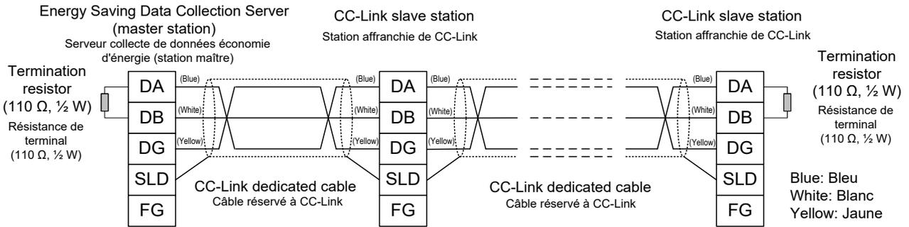
\* The attached white: 130Ω 1 / 2W CC-Link terminating resistor is not used. (La résistance de terminaison CC-Link blanche de 130Ω 1 / 2W ci-jointe n'est pas utilisée.)
