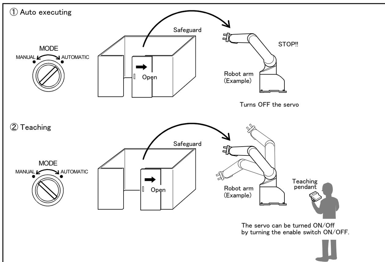
Fig.3-12 : Door switch function
