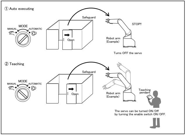
Fig.3-24 : Door switch function
