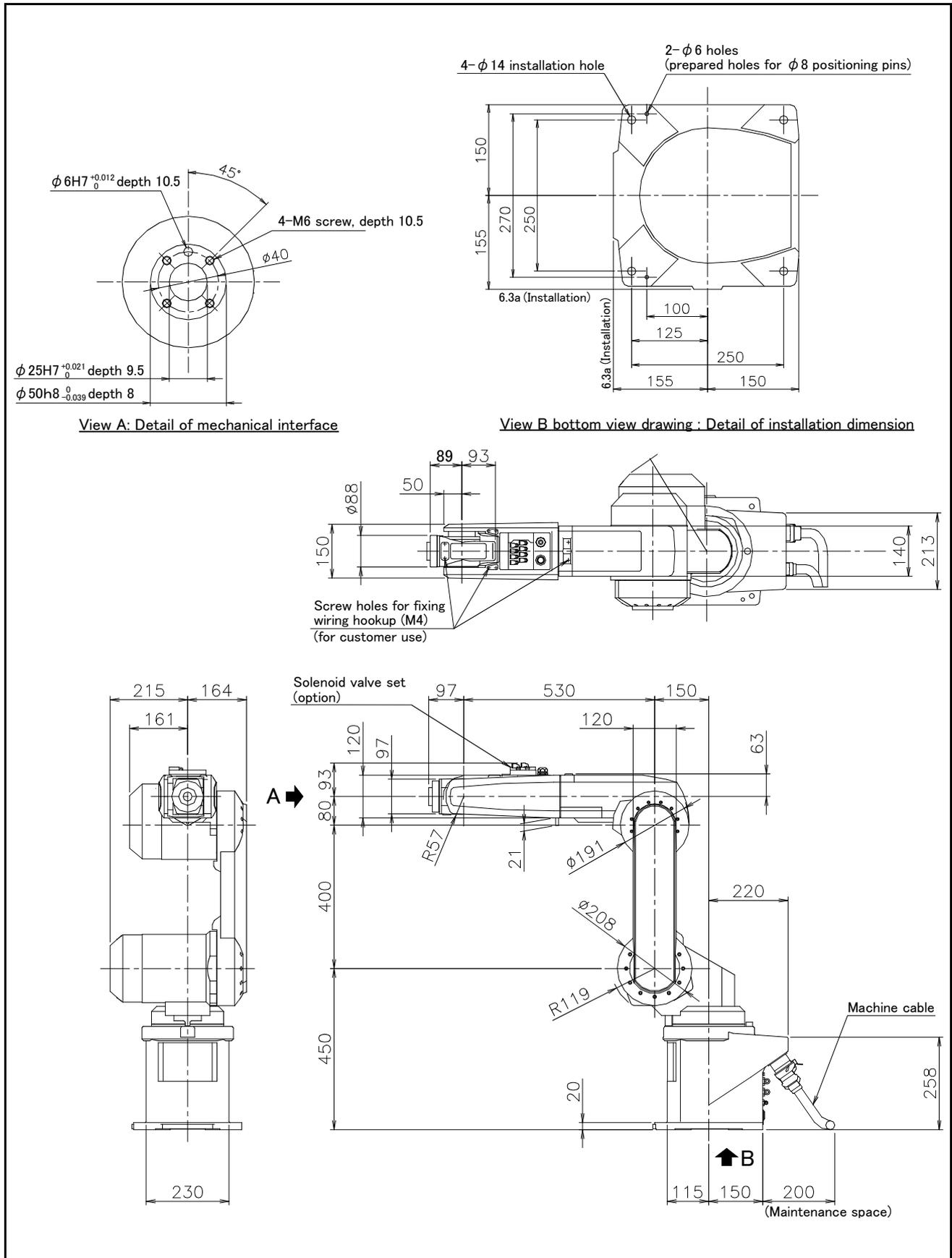
Fig.2-3 : Outside dimensions : RV-18SD-S/18SDC-S
