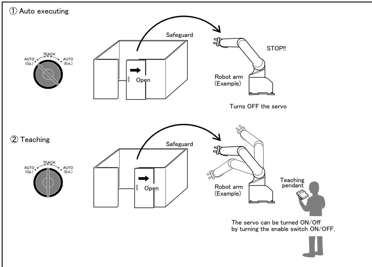
Fig.3-13 : Door switch function
