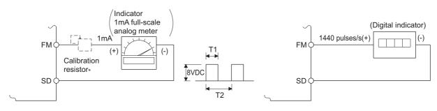
Pulse width T1: Adjust using calibration parameter C0
