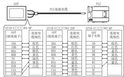
连接某些PLC时需要自制电缆。 详情请参考GOT2000系列连接手册。
