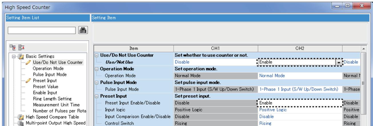
Navigation window ⇒ [Parameter] ⇒ Module model name ⇒ [Module Parameter] ⇒ [High Speed I/O] ⇒ "Input Function"
