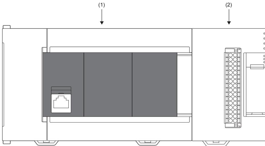
(1) CPU module (FX5U CPU module)
