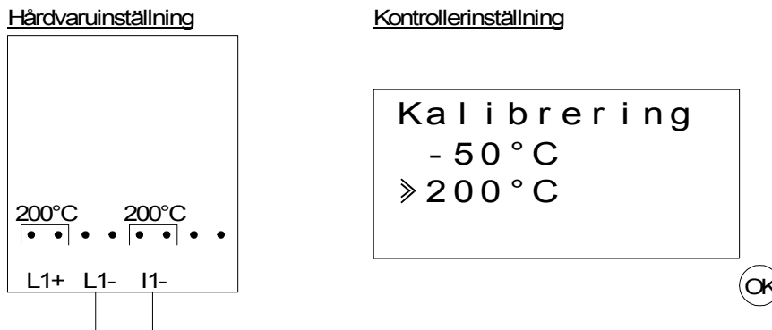
Figur 12.7: Avstämning av förstärkningen för AL2-2PT-ADP
