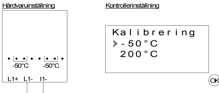
Figur 12.5: Avstämning av offset för AL2-2PT-ADP
