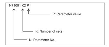
· Rotary axis configuration parameter
