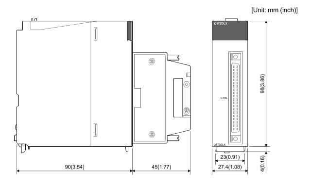
APPENDIX 2.3 Synchronous encoder interface module (Q172DEX)
